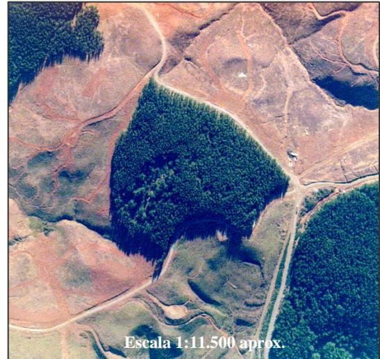
Figura 1: Fotografía aérea escaneada escala original 1: 5.000, tomada con cámara Hasselblad, con lente de 502 mm y negativo de 6x6 cm.
